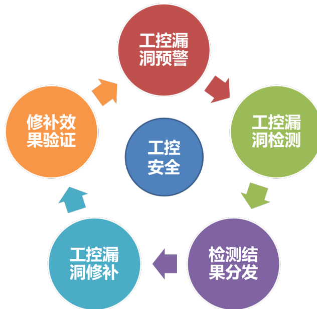
图 4-1 工控漏洞管理流程
