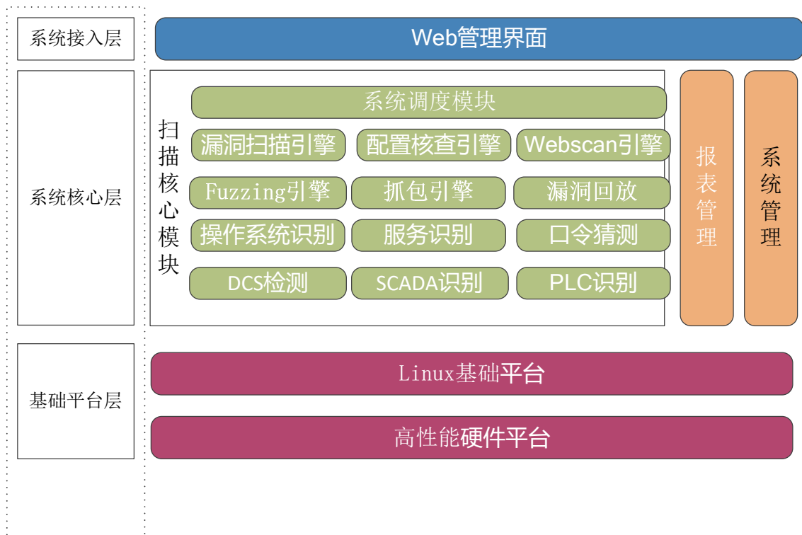
图 3-1 绿盟工控漏洞扫描系统架构图
